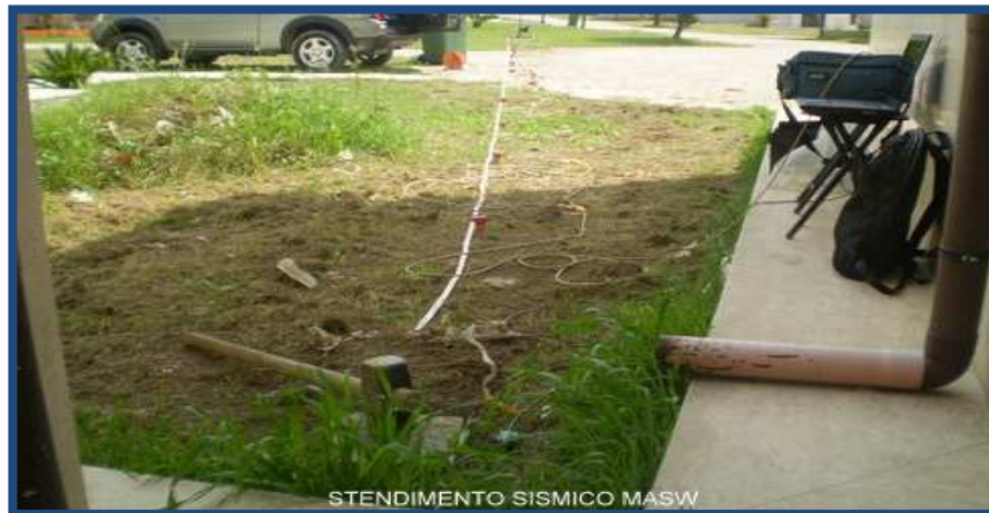
Figura 2: ESEMPIO DI STENDIMENTO SISMICO
